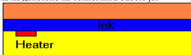
Схема на действие на техногията bubble jet
