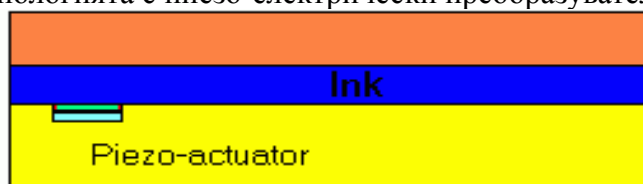
Схема на технологията с пиезо-електрически преобразувател
